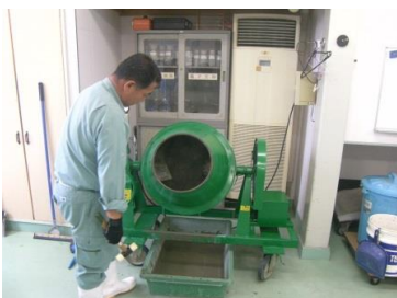
その3 ミキサーに材料を投入し数分間混ぜながら練る。
