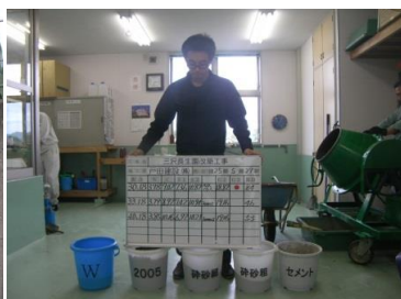
その2 試験体となる材料を正確に計測し、配合割合を確認する。
