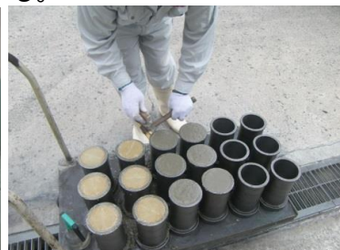
その6 最後に試験体を作成し、後に養生期間に応じた圧縮強度試験を行い、どの程度の圧力まで破壊されることなく強度を維持できるかのテストを行う。
