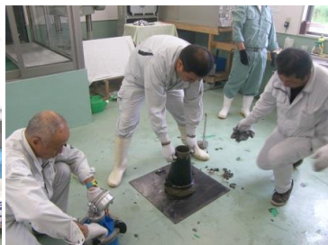
その4 スランプ試験器具にコンクリートを入れ、空洞ができないように詰め込む。
