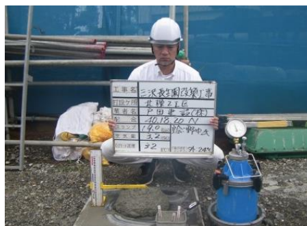
その4 スランプ試験器具にコンクリートを入れ、空洞ができないように詰め込む。
